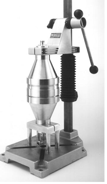
Die TEM - Messzelle Typ TEM -2000 dient zur Messung der Schirmdämpfung von elektrisch leitenden Kunststoffen, leitend beschichteten Kunststoffen, Abschirmmaterialien, Schirmgeflechten etc.
